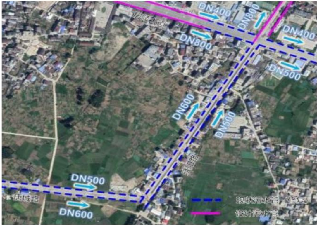
图 4-9 晓阳路污水管修复平面图
