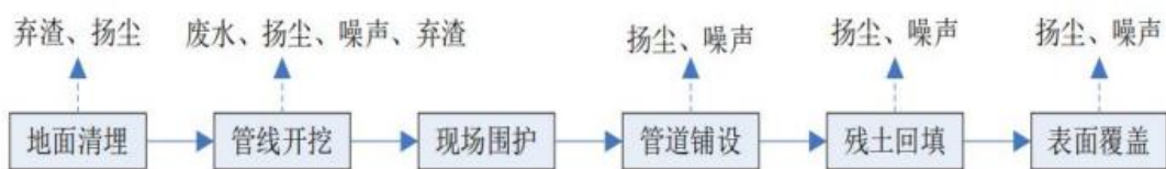
图 4-17 施工期开挖施工工艺流程图
