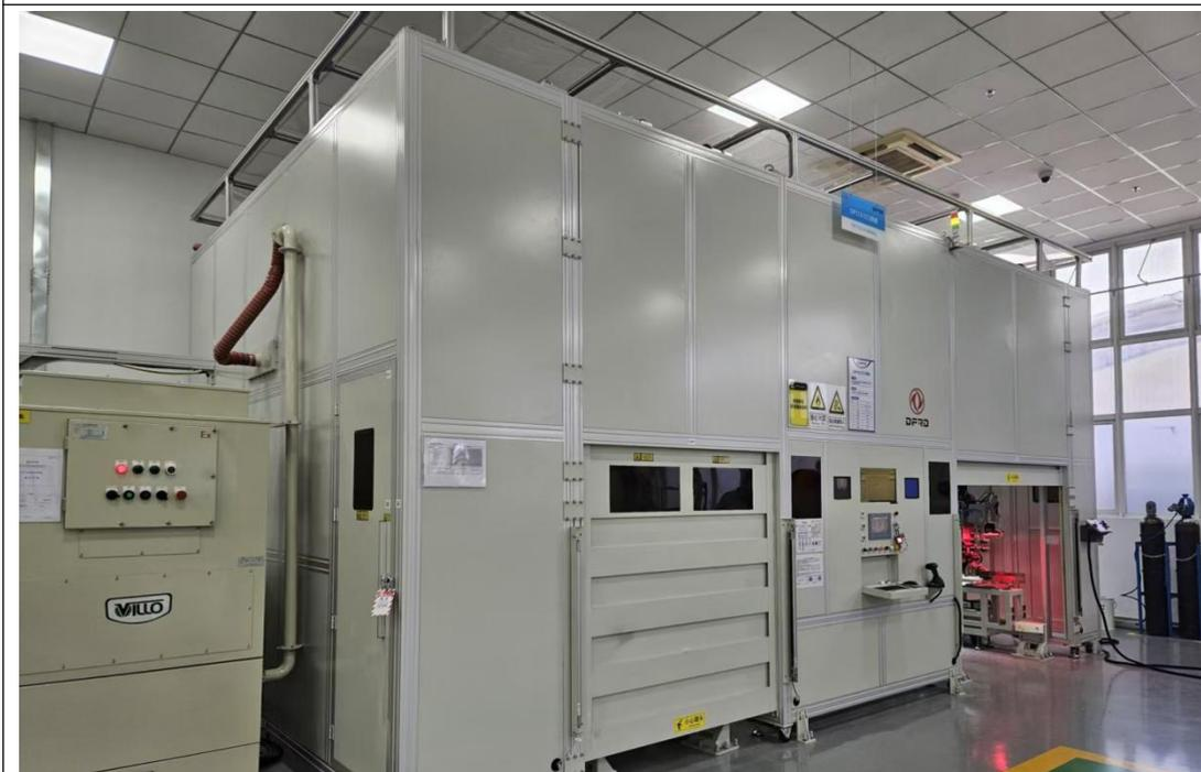
图 3-2. 焊接烟尘净化设施
